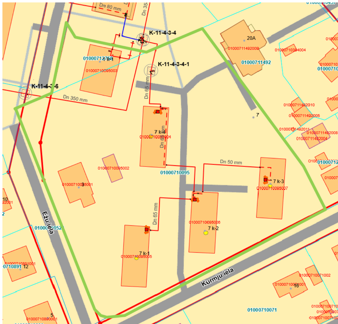
3.12. attēls. TmP teritorijā esošo siltumtīklu shēma
